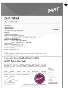
\* GHMT-zertifiziert für eine Übertragungsstrecke von 1x 24 m Verlegekabel plus 2x 3 m Patchcord im 2-Connector Channel (8.1-Standard Class I mit einer Betriebsfrequenz bis zu 2 GHz)
